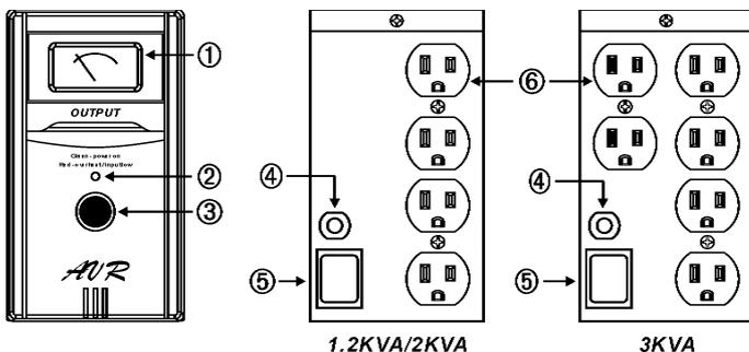
說明： $\text{Ⓜ}$ 輸出電壓錶       $\text{Ⓢ}$ 指示燈（綠色：電源開啟，紅色：
