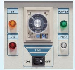
設定秒與分的電子計時器，可以設定測試時間
